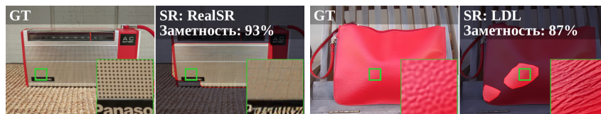
Рис. 1. Примеры заметных артефактов. Слева — из предлагаемого набора данных: модель RealSR размазала отверстия на панели радиоприёмника. Справа — из набора данных DeSRA: метод LDL сгенерировал текстурный артефакт (линии) на сумке. Заметность указывает долю ассессоров, подтвердивших наличие артефакта в выделенной области.
