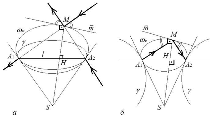
Рис. 5. Оптическое свойство гиперболического (а), эллиптического (б) цикла.
