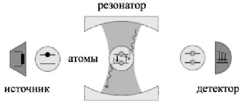
Рис. 1. Прибор для исследования взаимодействия квантованного излучения с атомами.
